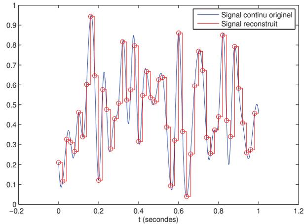
$F_s = 50$  Hz,  $T_s = 0.02$  secondes. Reconstruction de mauvaise qualité.
