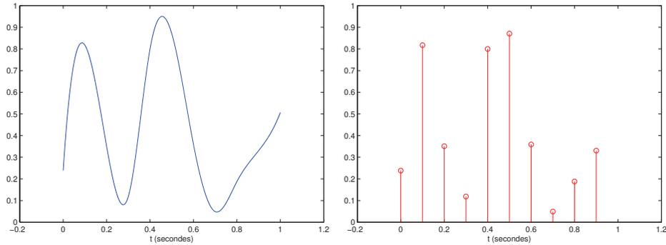
Le signal étudié ici varie de façon lente. On échantillonne le signal à  $F_s = 10$  Hz et on va essayer de reconstruire le signal à partir des seuls échantillons. Comment faire ?
